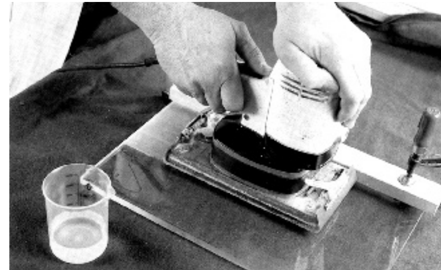
Abb. 11: Mechanisches Mattieren mit Schwingschleifer
